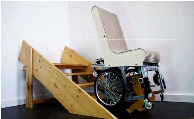
Abb. 12: Das Demonstrator-Modell während des Treppensteigens; die Beine befinden sich unterhalb des Rollstuhls und schieben ihn von Stufe zu Stufe.
