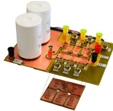
Realisierte Teststruktur für die Charakterisierung des Betriebsverhaltens der Leiterplattenintegrierten Leistungshalbleiter-Schalter
