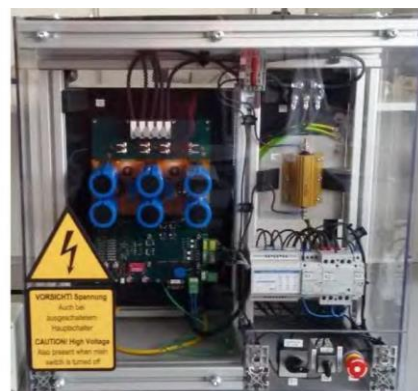
Fotografie des realisierten Antriebsumrichters im Versuchsstand.
